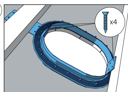
FI Aluskatteen 2K-tiivisteiden asennus SV Installation av 2K-Undertaksbeslag DE Installation der Underlay-2K-Dichtung NL Installatie van de 2K-afdichting voor de onderlaag
