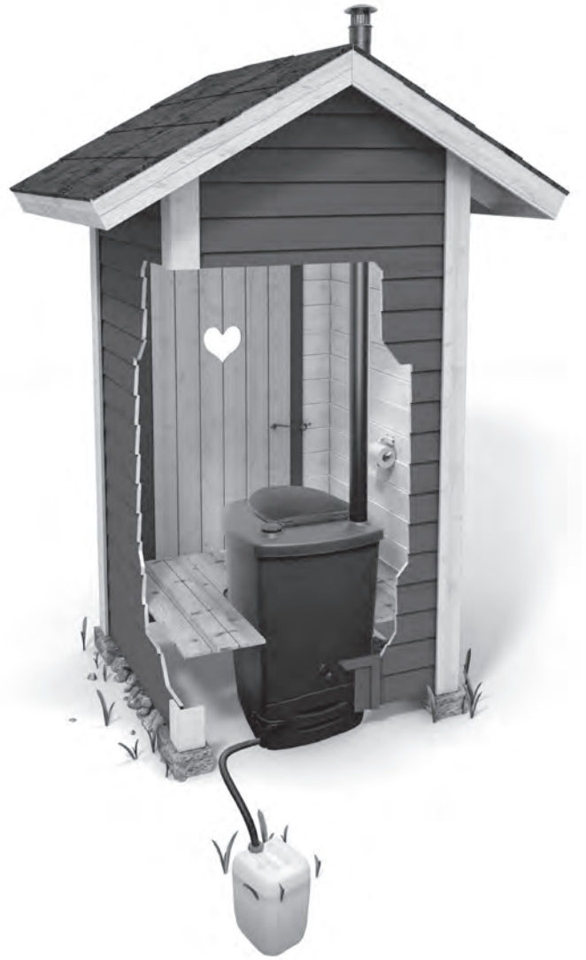
Esimerkkikuva käymälän asennuksesta ja nesteenpoistokanisterin sijoituksesta.
