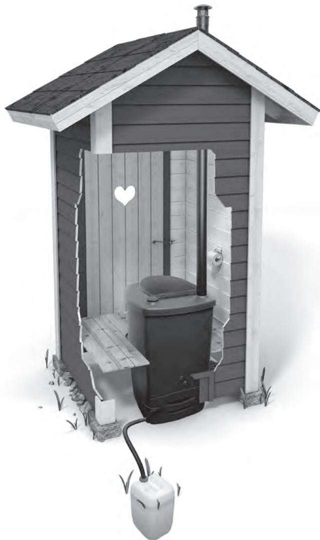
Eksempelbilde på toalettinstallasjonen og dreneringsbeholderens plassering
